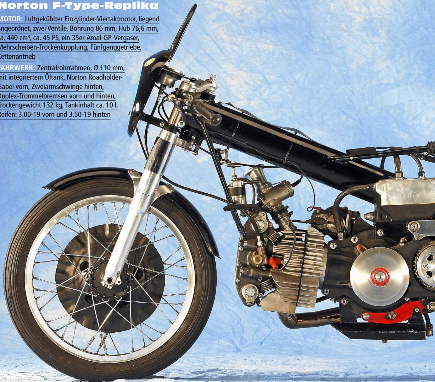
besaßen nämlich einen Unit-Motor mit integriertem Getriebe, dessen Primärtrieb über zwei Zahnräder eine „rückwärts“ drehende Kurbelwelle erforderte. Zu viel Aufwand, entschied Franz – und baute eine eigene Lösung, mit dem Fünfganggetriebe der Manx im angepassten Gehäuse (siehe Motoraufbau auf Seite 25). Deshalb treibt die Sekundärkette bei seinem Nachbau das Hinterrad auf der linken Seite an, beim Original ist es genau anders herum.
